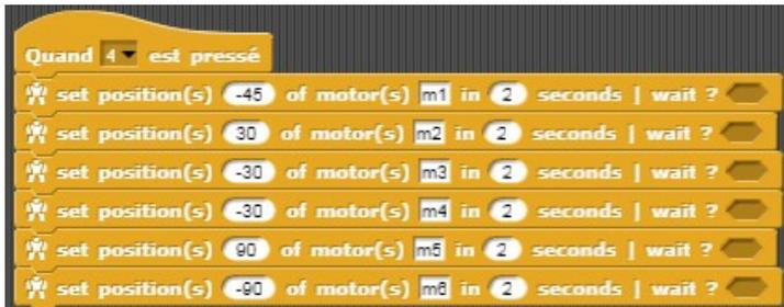
11) Assembler les blocs ci-contre et observer le comportement du bras robot en appuyant sur la touche « 4 » puis sur la flèche du haut.
